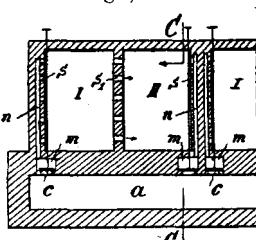
(a) verbindbar ist, anderseits mit Kanälen (n) und Öffnungen (s) in der darüberstehenden Wand der Kammerpaare in offener Verbindung steht. — Es sind Trockenanlagen bekannt, bei denen die Trockengase wechselweise in verschiedenen Richtungen durch alle Kammerpaare hindurchgeführt werden. Gegenüber diesen Anordnungen besteht das Wesen der Erfindung darin, daß die Trockenanlage aus einer größeren Zahl von
